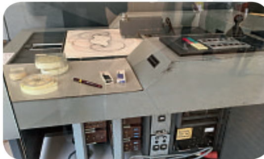
Zuse Z64 Graphomat: automatischer Zeichentisch, der durch Lochstreifen gesteuert wurde. Durch seine robuste Mechanik konnte er auch zum Zuschneiden von Kartons und Folien eingesetzt werden.
